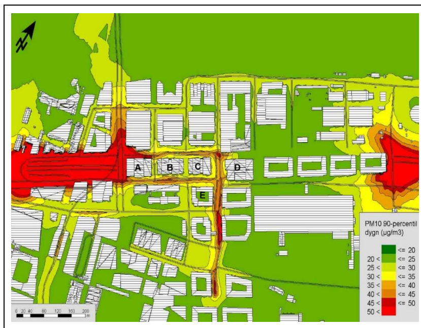
Figur 9 Haltkartor för luftkvalitetsberäkningar för 90-percentilen för dygnsmedelvärdet av PM_{10} år 2035. Gul haltgräns indikerar gränsvärdet för miljömålet, röd markerar haltgränsen för MKN. Byggnaderna är markerade med bokstäver.
